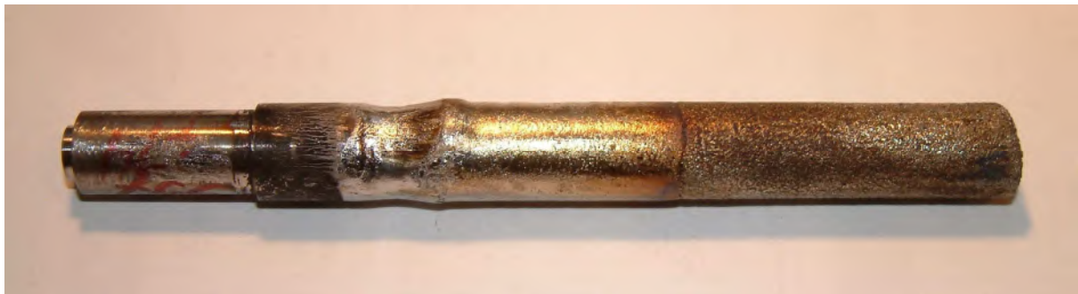
Rysunek 10. Ślady erozji wewnętrznej elektrody akceleratora IPD.
