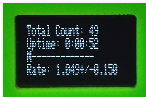
Rys. 3. Przykładowy widok wyświetlacza licznika CosmicWatch w czasie trwania pomiaru
