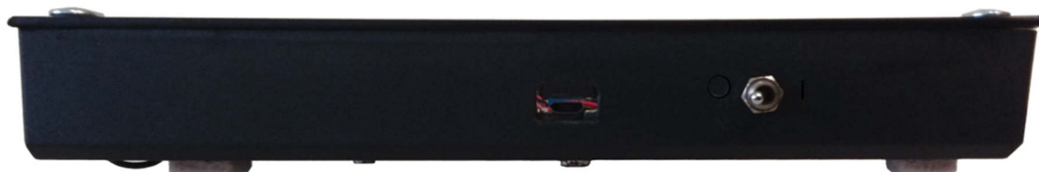
Rys. 2. Widok prawej ścianki licznika (widoczny włącznik/wyłącznik i złącze microUSB)
