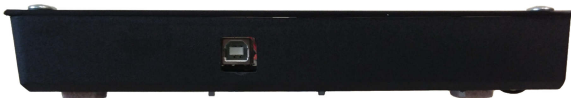
Rys. 3. Widok lewej ścianki licznika (widoczne złącze USB typu B)
