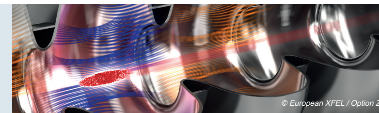
Komputerowa wizualizacja procesów przyspieszania elektronów we wnętrzu nadprzewodzącego rezonatora.
