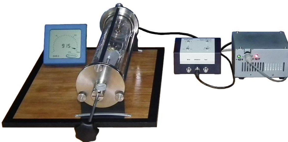
Rys. 1. Elementy układu pomiarowego: (od lewej) ciśnieniomierz, komora próżniowa z detektorem promieniowania i źródłem, przedwzmacniacz, zasilacz przedwzmacniacza.
