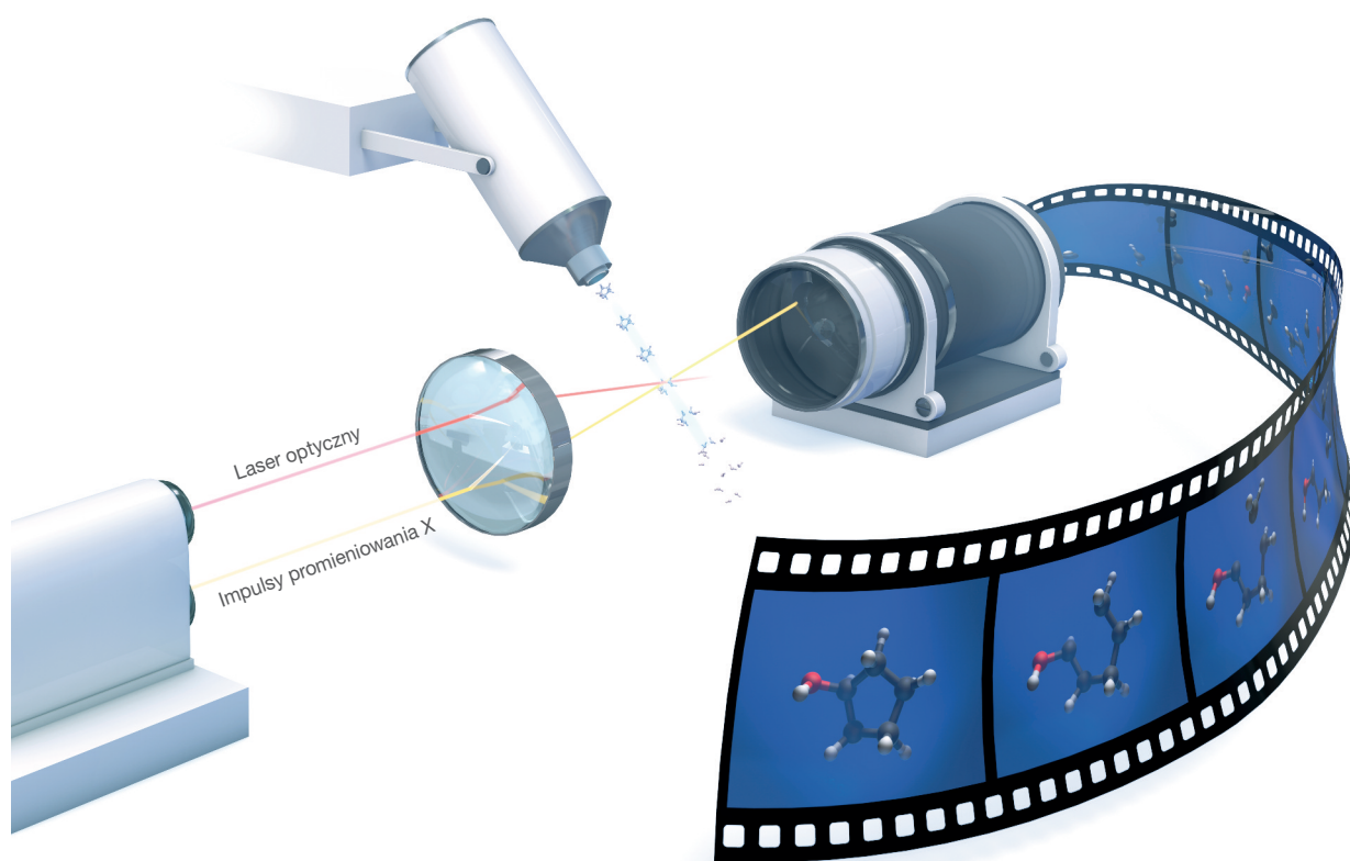
Rys.9 Filmowanie procesów zachodzących w molekułach. Najpierw błyskiem lasera optycznego wyzwała się reakcję chemiczną. Kolejne impulsy z lasera XFEL wysyłane w coraz dłuższym odstępie czasu po pierwszym impulsie optycznym robią "migawki" zmieniającego się stanu molekuly (kolejne klatki filmu).
