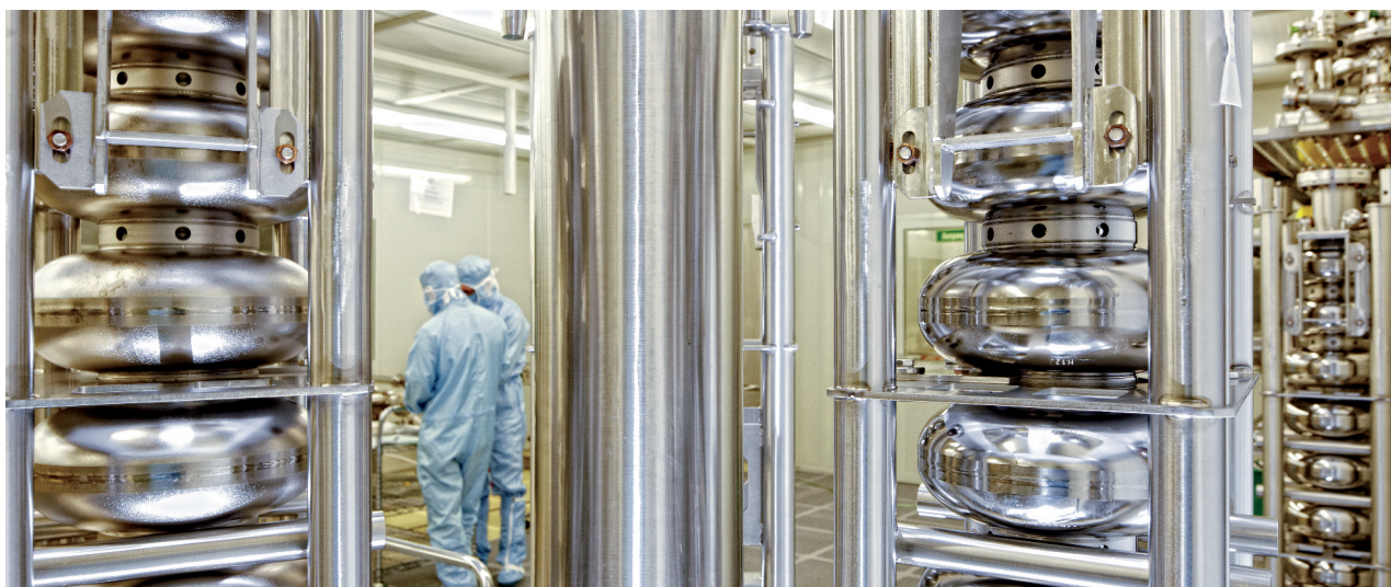
Rys.12 Bazowane na rezonatorach z niobu technologie akceleratorowe opracowane na użytek European XFEL już wpłynęły na rozwój liniowych akceleratorów elektronów na całym świecie.
