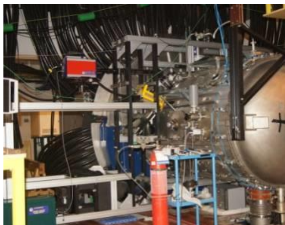
Rys. 26 W żółtych ramach nośnych FNYM zamocowany na stałe do ściany komory próżniowej PF-1000
