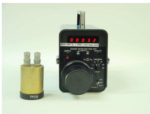
Rys. 2. Miernik RDA-200 firmy Pylon (Kanada) do pomiaru chwilowych stężeń radonu.
