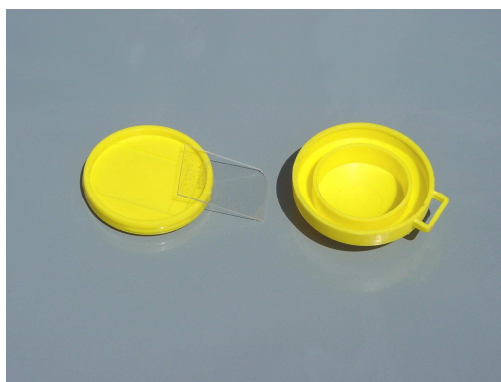
Rys. 1. Rozłożona kasetka dozymetryczna typu NRPB z detektorem CR-39.
