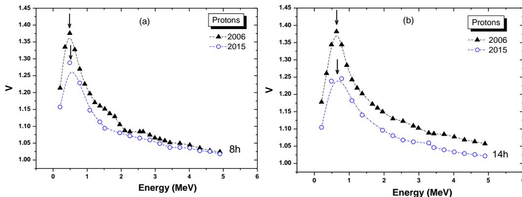
Rys. 6. (a, b). Variation of the sensitivity function  $V=V_T/V_B$  measured in 2006 and 2015 for different etching times (8 and 14 h). The arrows on the figures indicate the positions of the maxima of the sensitivity function. Zmiana funkcji czułości  $V=V_T/V_B$  w okresie od 2006 do 2015 dla różnych czasów trawienia detektora.
