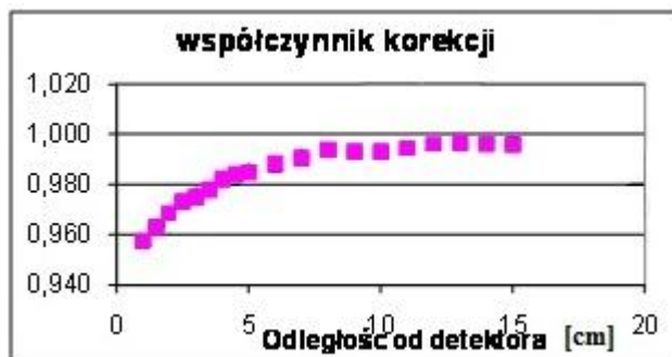
Rys. 3.25 Przykładowa krzywa korekcyjna dla rozmiaru próbki 2x2 cm. Na osi Y stopień korekcji. Na osi X odległość [cm] umieszczenia próbki od detektora. [5]
