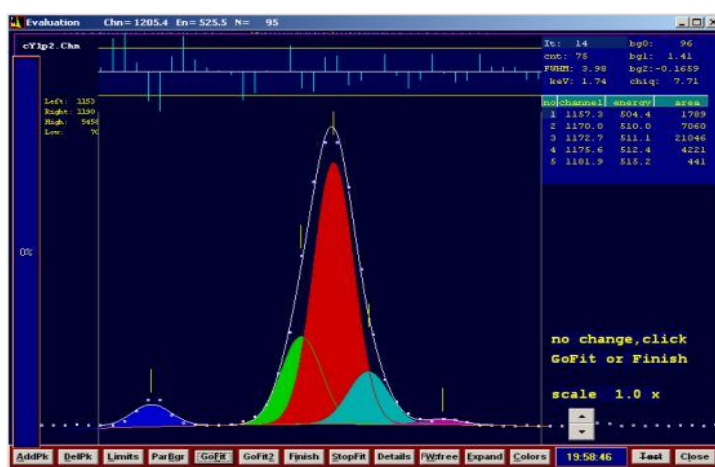
Rys. 3.12 Obraz z programu DEIMOS [35] używany do analizy uzyskanych widm gamma. Program analizuje widmo dzieląc go na małe przedziały po kilkadziesiąt keV. Rysunek ukazuje problem z analizą linii 504,45 keV (z izotopu Y-85 – ciemno niebieska linia) i linii 514 keV (z izotopu Sr-85 – jasno niebieska), znajdujących się w bezpośrednim sąsiedztwie linii 511 keV – czerwona linia (anihilacja elektron-pozyton)
